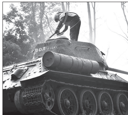
Pieskovanie bolo prvým krokom pri rekonštrukcii tanku.
